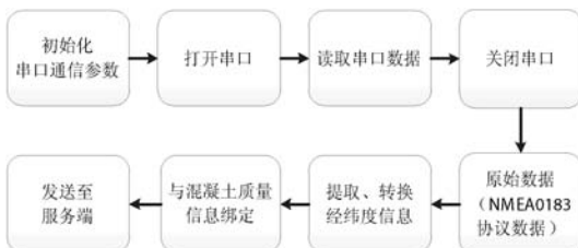
图3 GPS 定位数据获取流程
