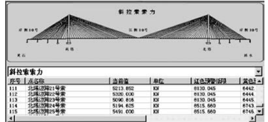
图5 大桥索力监测界面
